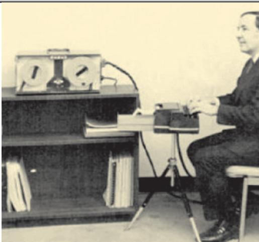
«Х. Аврам показывает, как магнитофон используется для записи символов, набранных на модифицированной стенографической машинке. Эта система может использоваться для компьютерной транскрипции судебных разбирательств; лента (сошедшая со стенографической машинки – В.Н.) вставляется в компьютер, который распечатывает текстовый перевод заметок» (фото и текст из «Technical News Bulletin» за август 1972-го)
